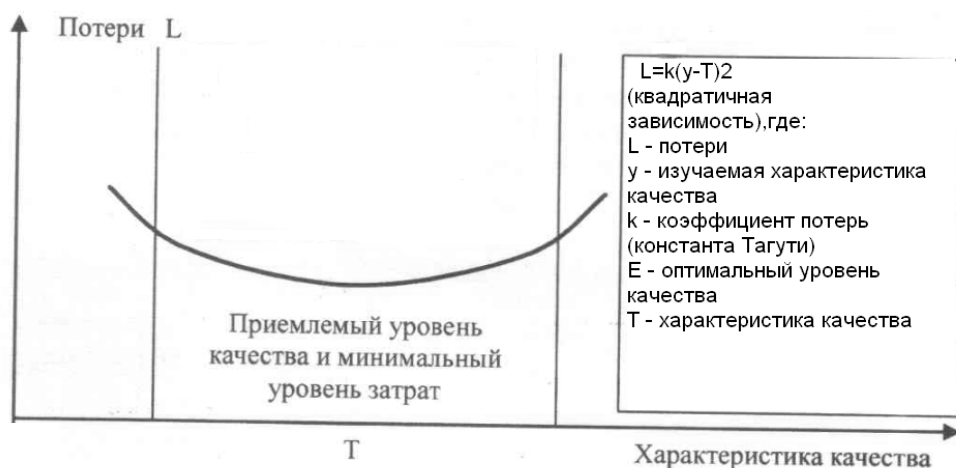
Рис. 5. Квадратичная зависимость потерь качества по мере отклонения от его необходимого уровня (функция потерь Г. Тагути)
