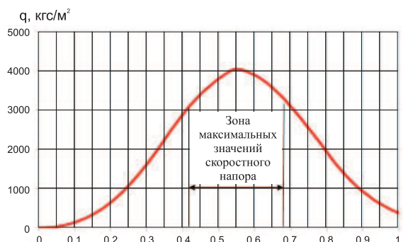
Рис. 1. Зависимость скоростного напора от относительного времени полета первой ступени
