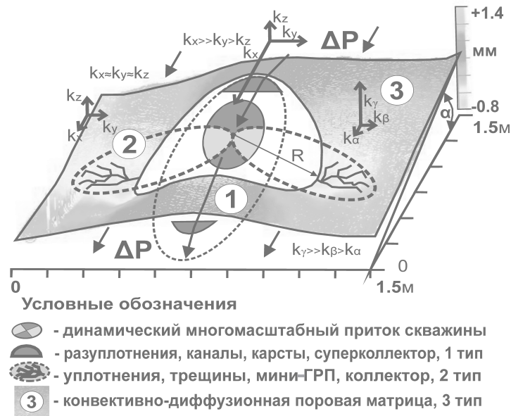
Рис. 1. Высота рельефа D_1 и деформаций D_2 разуплотненной (1), уплотненной (2) и застойной (3) зон при одноосном нагружении поровой структуры проницаемости k_\alpha вязким стоком скважины
